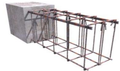
Fig115 : poteau en béton armé
