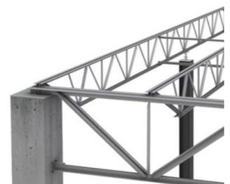
Fig112 : portique poteaux-poutres (béton/acier)
