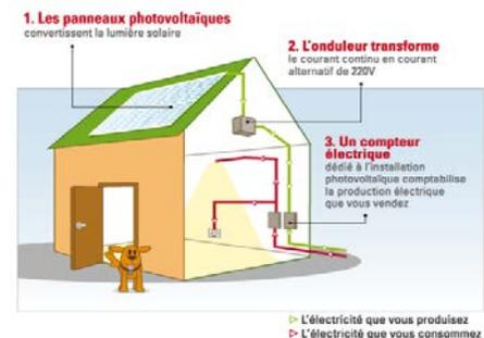
Fig134 :système de fonctionnement d'un solaire électrique
