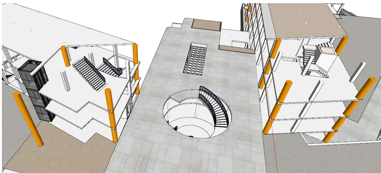
Figure 96 : Colonnes supportant les blocs supérieurs. Source : auteurs
