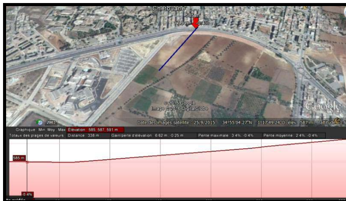
Fig. 3.18 : représente la coupe AA du terrain
