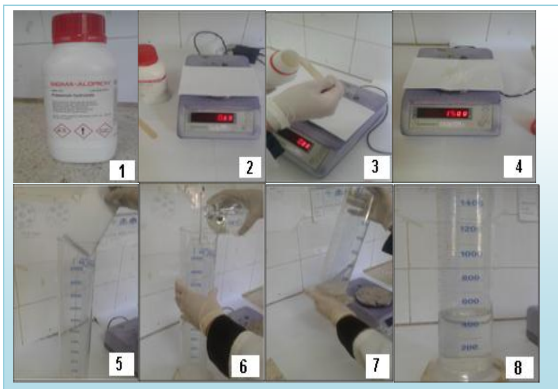
Figure 30: Procédure de préparation d'hydroxyde de potassium à 30% (photo TIB H, CHU de Tlemcen, 2017)
