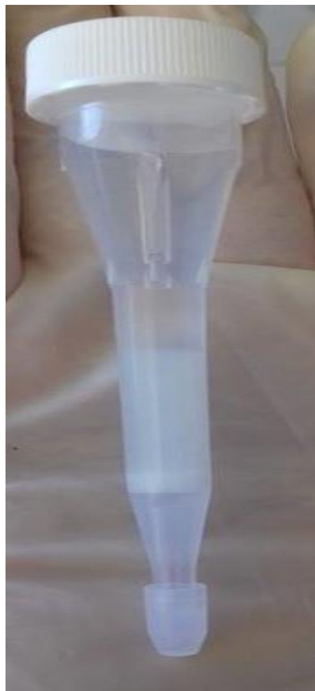
Figure 38: Colonne échangeuse de cations pour la chromatographie de l'hémoglobine A2 (Photo originale)
