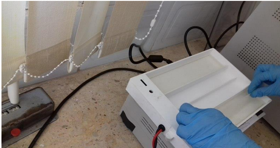
Figure 32: Préparation de la chambre de migration (photo originale)
