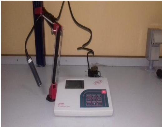
**Figure 23 :** Conductimètre.
