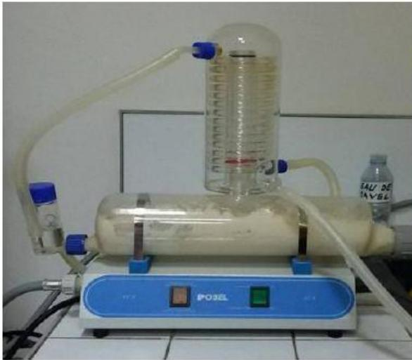
**Figure 27** : Distillateur à simple effet
