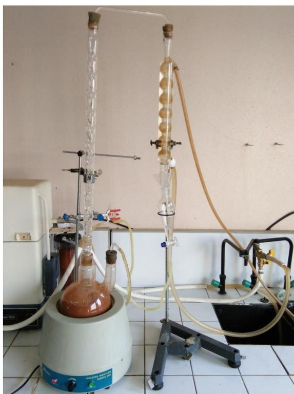
**Photo (03) : Montage d'un appareil d'hydrodistillation**
