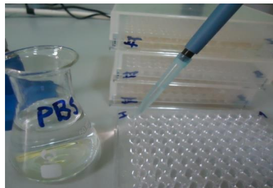
Fig .2. Lavage des microplaques par la solution PBS
