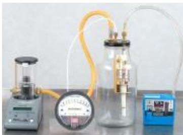
Figure 1.4 : Étalonnage avec un cyclone
