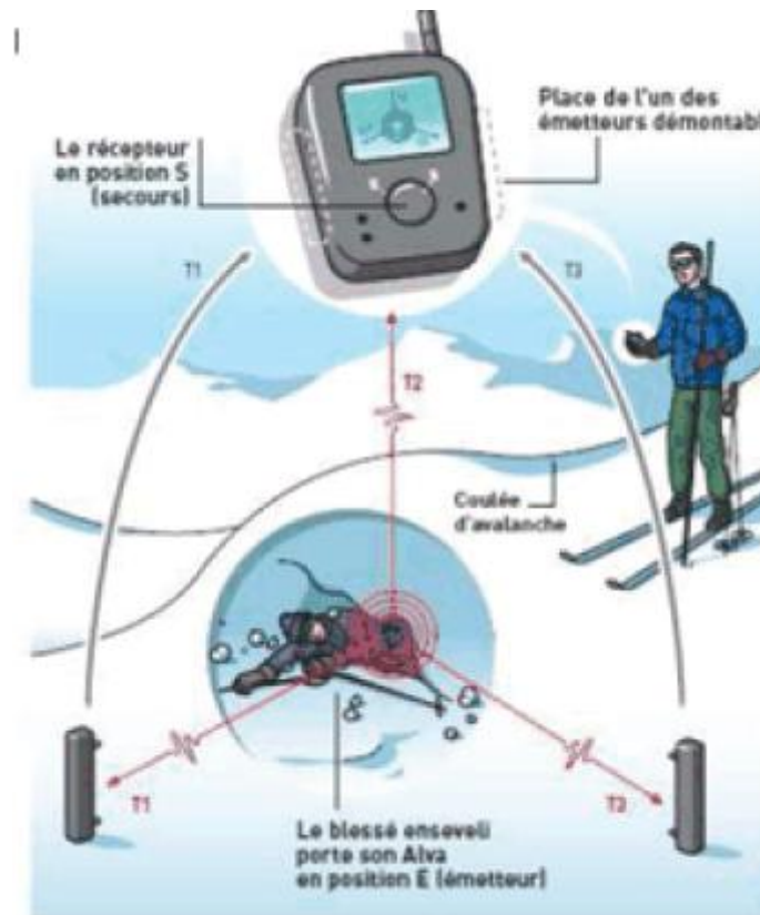
Figure I.3: Détection de personnes ensevelies sous la neige par le système ALVA.
