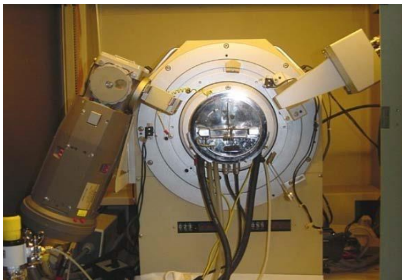
Figure II. 7. Diffractomètre D5005 (Bruker)[6].
