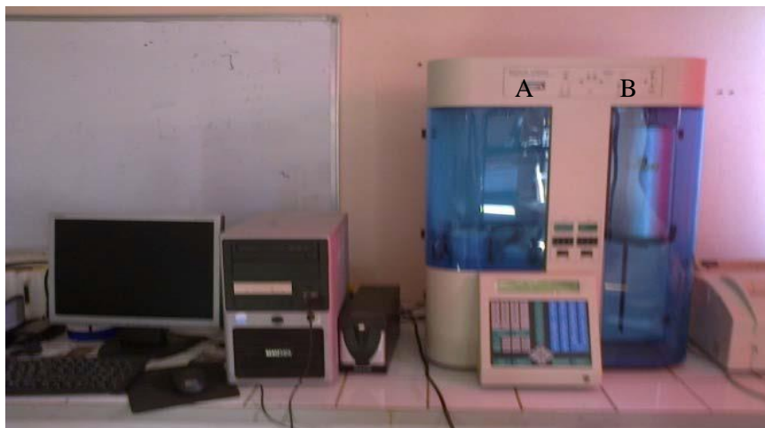
Figure II. 10. Appareil NOVA 1000e employé pour les mesures BET.
