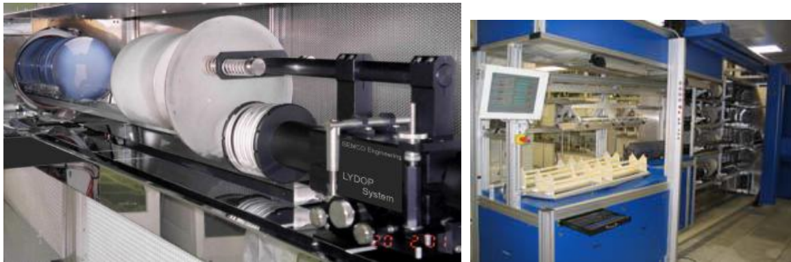
Fig. IV.16 : Système de diffusion LYDOP® (Source : Semco Engineering)
