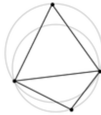
Figure B.5. Le basculement d'arête produit une triangulation de Delaunay.
