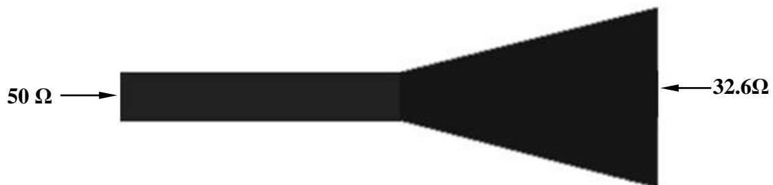
Figure I.18. Schéma de la ligne de transition vers un guide GIS sous ADS®.
