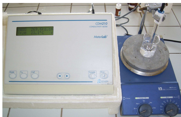
Figure 3: Conductimètre utilisé avec sa cellule électrolytique.
