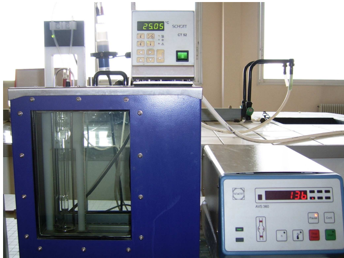
Figure 1: Viscosimètre à capillaire utilisé type Ubbelohde
